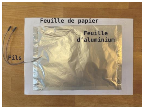
Figure 2. Photographie d'une face du capteur de pression capacitif « artisanal »
